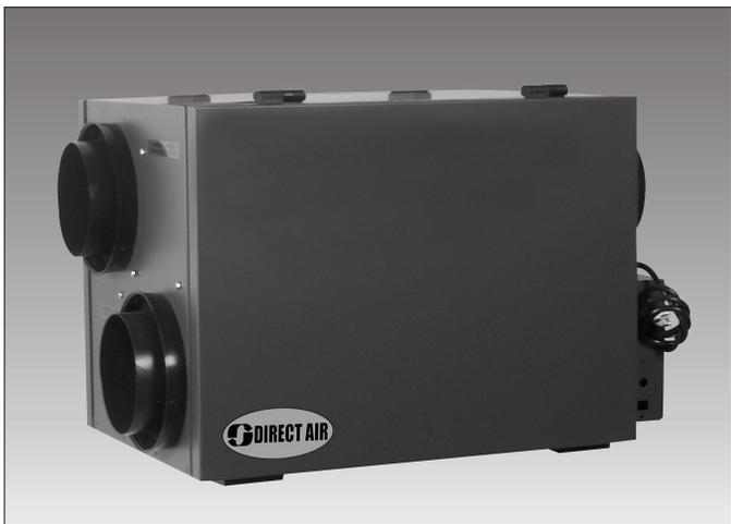
La série PHRV200 ventilateurs-récupérateurs de chaleur (VRC) de Powrmatic. Tout comme dans le cas des modèles précédents, le flot d'air frais entrant est filtré avant d'être chauffé par l'air vicié sortant par l'intermédiaire d'un noyau récupérateur de chaleur en polypropylène. Le VRC répartit alors l'air filtré frais préchauffé dans la maison grâce au réseau de conduits solidaires de l'appareil ou au réseau de conduits d'un système à air pulsé.
